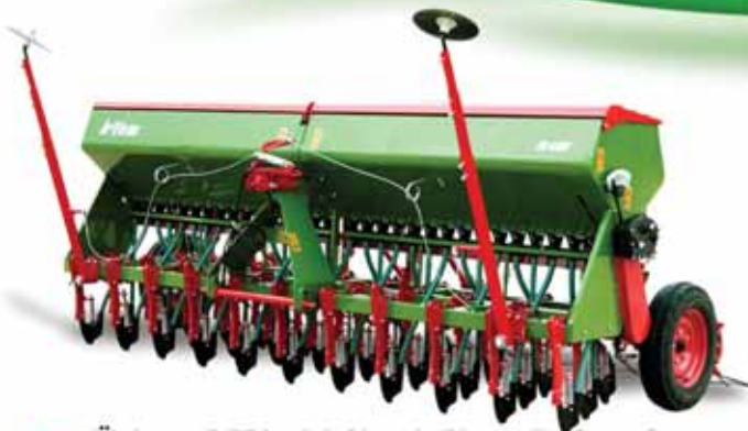
Üniversal Ekim Makinesi (Uçtan Yaylı Ayak) Universal Seed Drill (Spring Load Couler)
