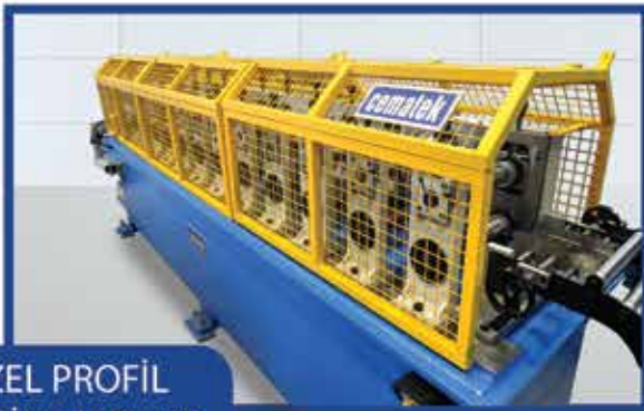
PERFORE METAL ASMA TAVAN ÜRETİM HATLARI
